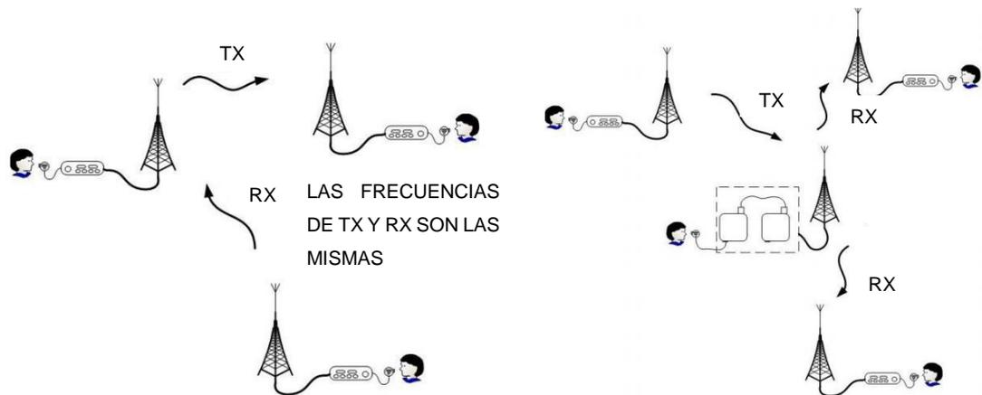
Figura 9. VHF sin y con repetidor de voz
