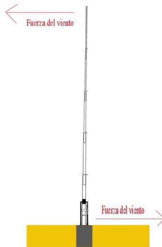
Figura 26 Antena con base de soporte para viento
