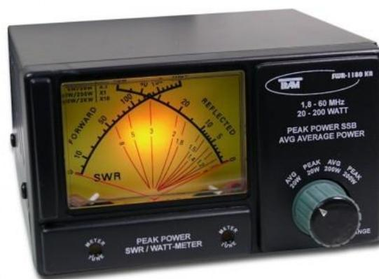
Figura 25: Medidor de ROE del tipo de agujas cruzadas
