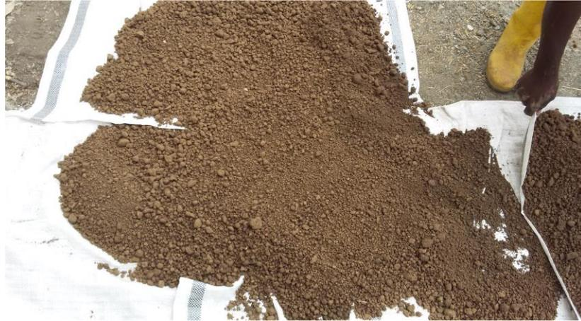
**Ilustración 25. Arena+Grava con 90% de arcilla y 10% de lodos residuales.
