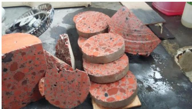
**Ilustración 40. Muestras de la sección transversal y longitudinal de los cilindros de hormigón ligero con agregado 90% de arcilla y 10% de lodo residual. Fuente: Autor**
