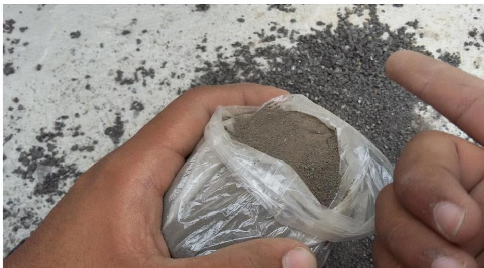
**Ilustración 21. Material fino de lodo residual, antes y después de ser triturado.**
