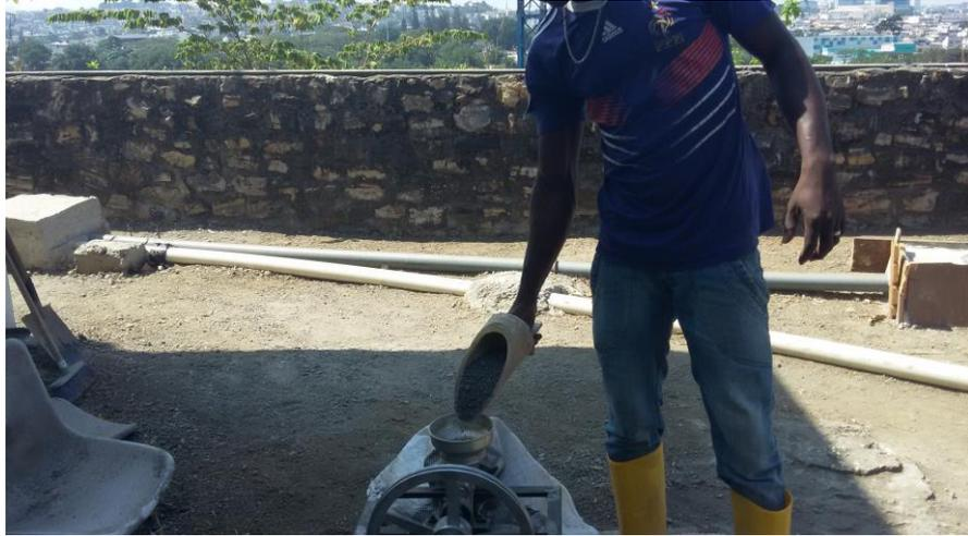
**Ilustración 10. Proceso de trituración de los lodos residuales. Fuente: Autor**
