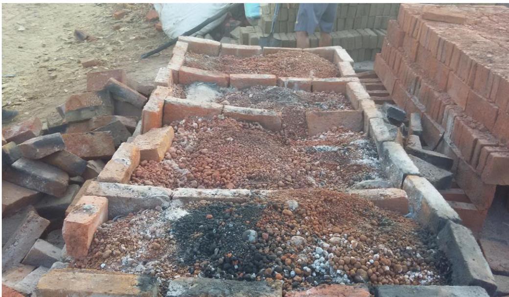
**Ilustración 29. Áridos después del proceso de cocción. Fuente: Autor**
