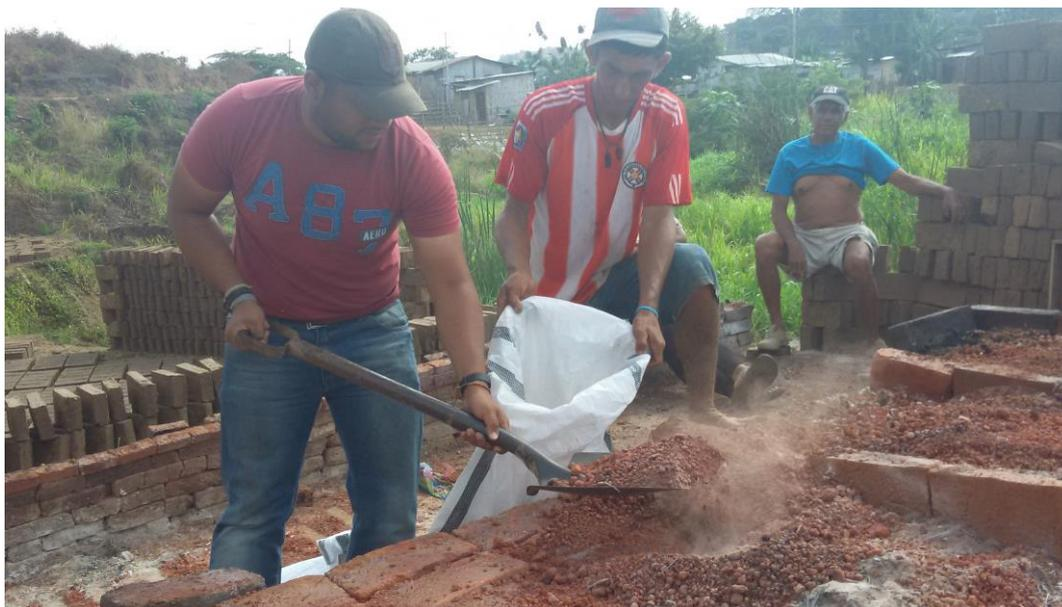
**Ilustración 30. Áridos después de la cocción. Fuente: Autor**
