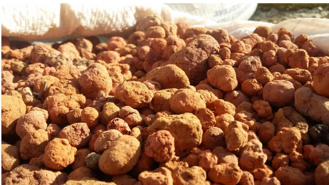
**Ilustración 31. Áridos de arcilla con 10% de lodo residual, después de la cocción, listas para ser usada como agregado para el hormigón. Fuente: Autor**
