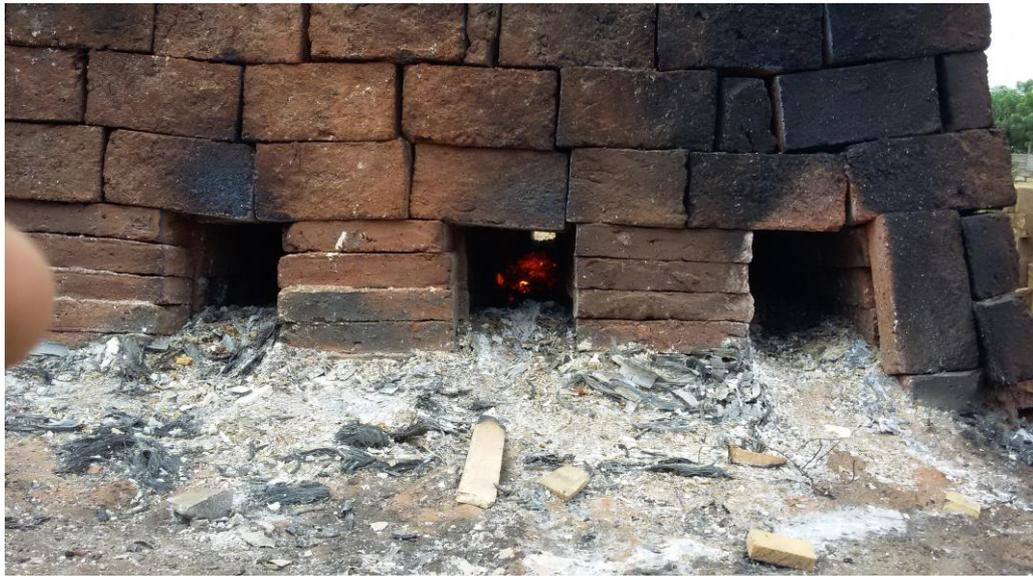
**Ilustración 28. Horno artesanal para la cocción de los áridos. Fuente: Autor**
