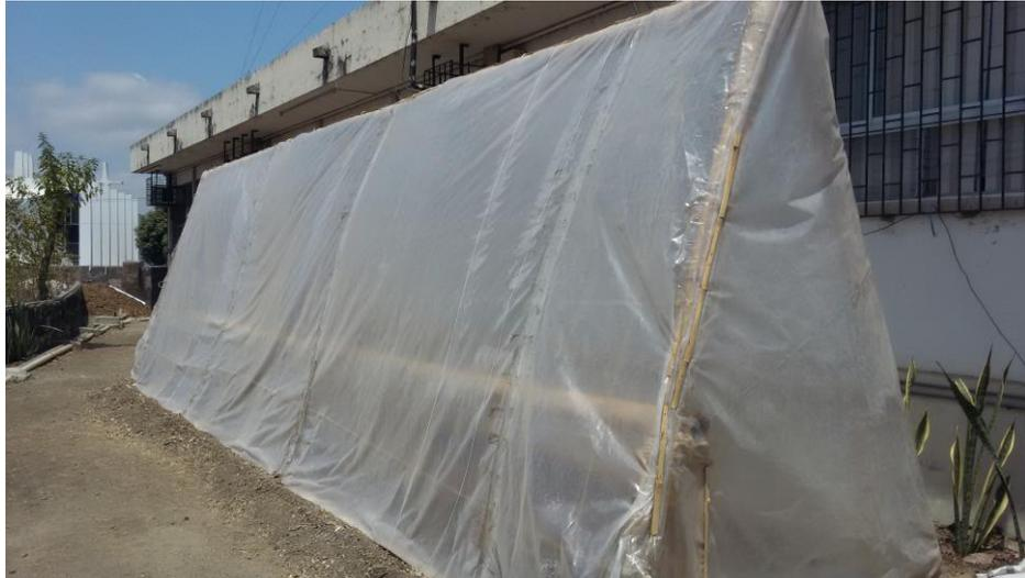
**Ilustración 18. Colocación de las primeras muestras Arcilla de la formación Piñón, en la cámara de secado. Fuente: Autor**
