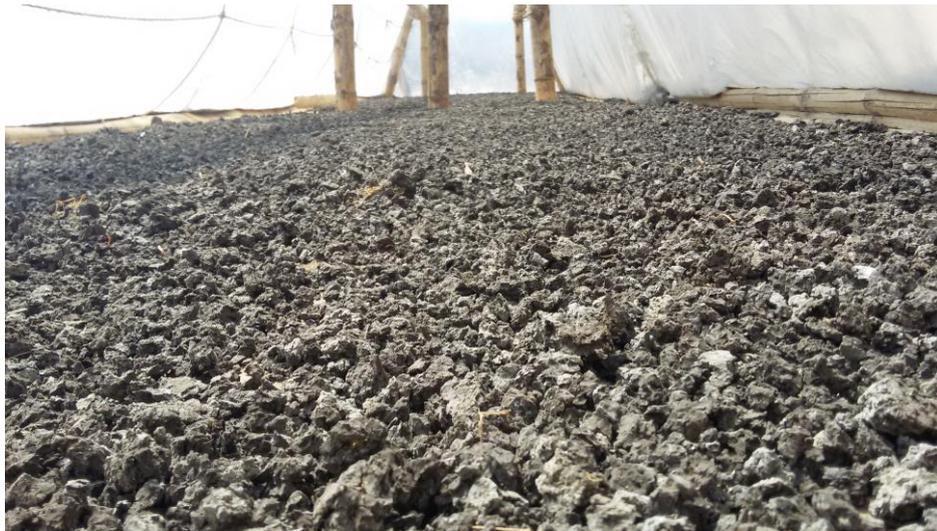
**Ilustración 9. Lodos residuales iniciando el proceso de secado. Fuente: Autor**
