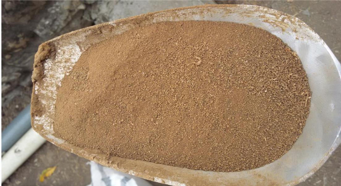
**Ilustración 22. Arcilla de la formación Piñón después del proceso de secado.
