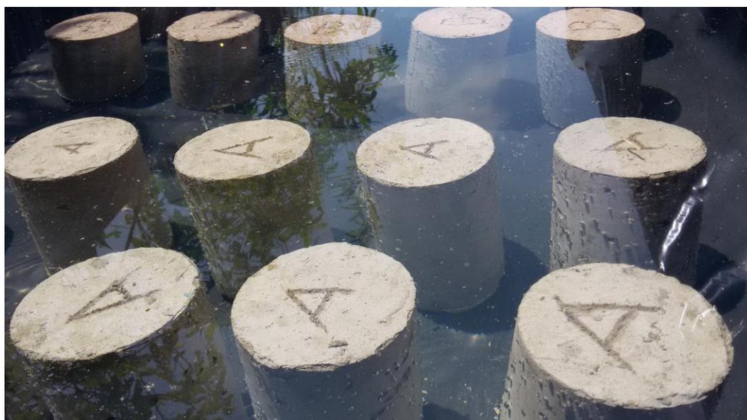
**Ilustración 33. Cilindros de hormigón tipo A (experimental) y B en la piscina de curado. Fuente: Autor**
