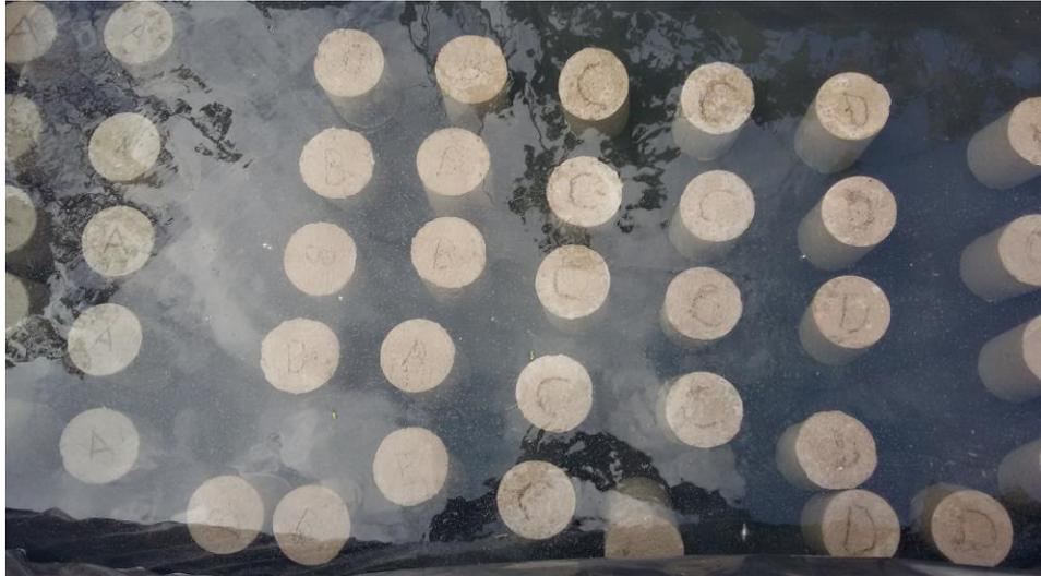
**Ilustración 34. Cilindros de hormigón en la piscina de curado. Fuente: Autor**
