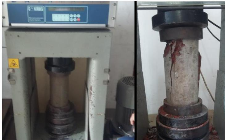
**Ilustración 37. Prensa para el ensayo de compresión de los cilindros, antes y después de aplicar el ensayo. Fuente: Autor**
