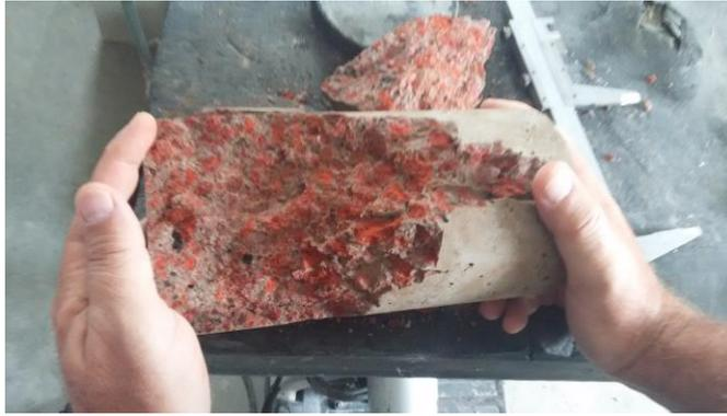
**Ilustración 39. Zona de falla en cilindro de hormigón ligero con agregado 90% de arcilla y 10% de lodo residual. Fuente: Autor**
