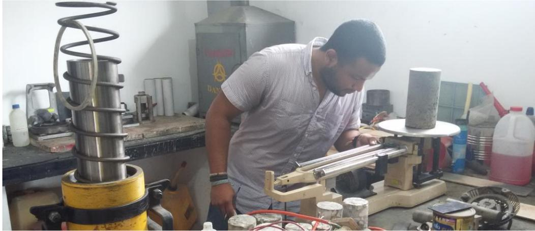
**Ilustración 36. Pesando los cilindros antes de aplicar el ensayo de compresión simple. Fuente: Autor**
