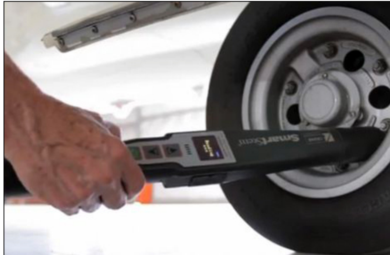
Figura 3.6: Un usuario coloca el lector RFID de mano SmartStem sobre el medidor de presión que transmite la temperatura, la presión y el número de identificación único del neumático.
