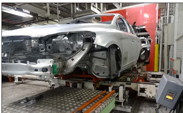
Figura 3.8: Ensamblaje de varios modelos de vehículos Volvo en la misma línea de producción.
