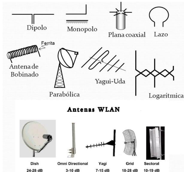
**Figura 2. 8 Diferentes tipos de Antenas**
