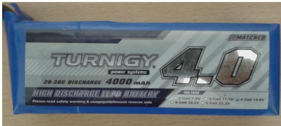
Figura 3. 5: Batería LiPo de 4 celdas (4S)
