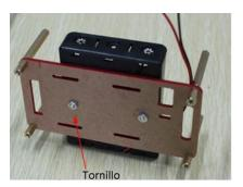
Figura 3. 19: Soporte de motores en base de acrílico. Elaborado por: Autores.
