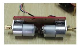
Figura 3. 18: Soporte de motores en base de acrílico. Elaborado por: Autores.
