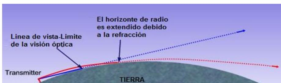
Figura 5. Las señales refractadas van más allá de la línea de visión óptica
