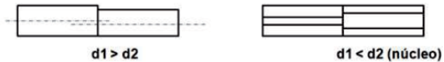
Figura 2 15: Empalme de núcleo con dimensiones distintas Fuente: (Xinos, 2010, p. 26)
