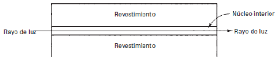
Figura 2.5. Rayo de luz proyectado en una fibra Monomodo
