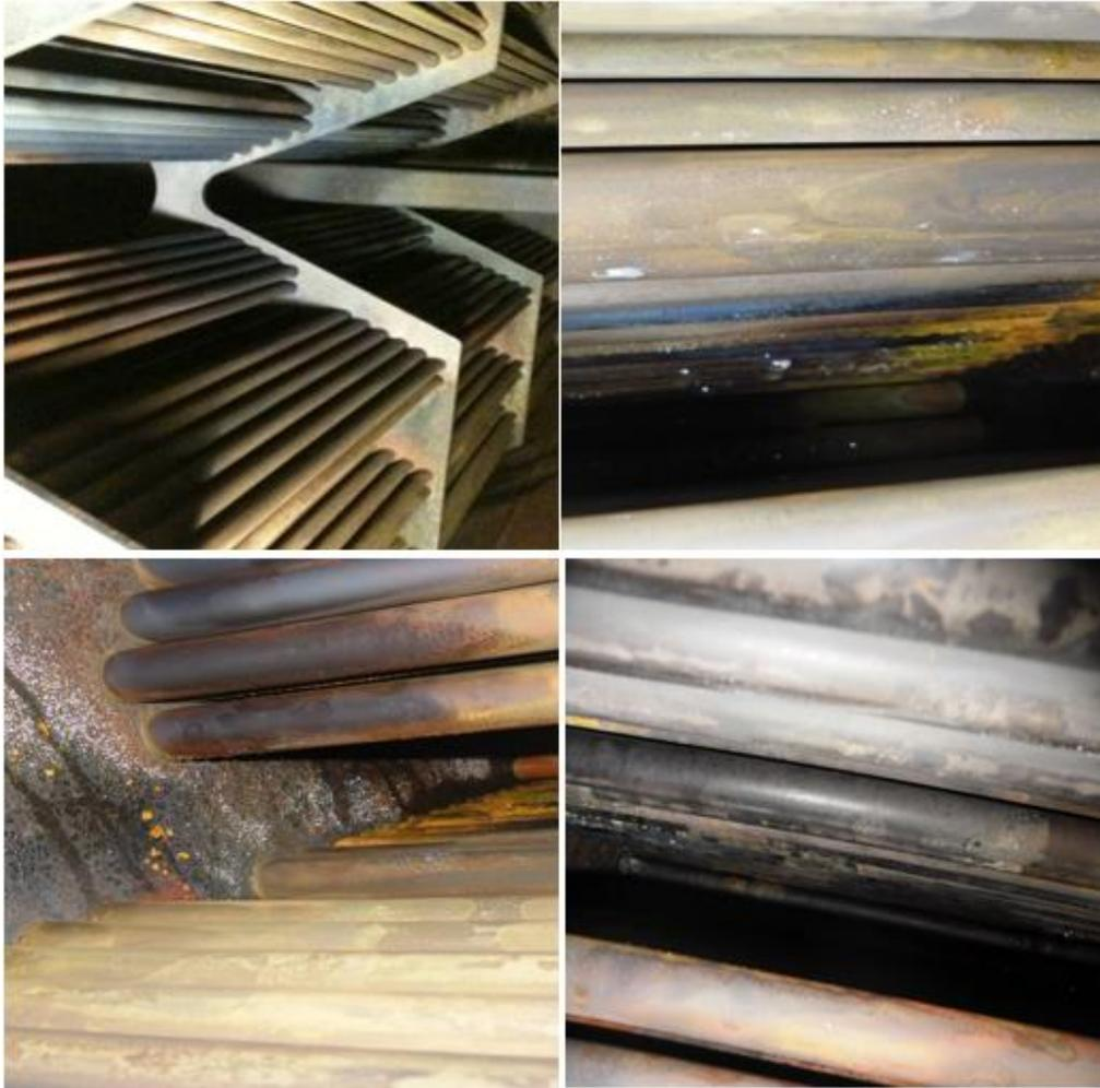
Figura 3. 19: *Rotura de Tubos en el Condensador.*
