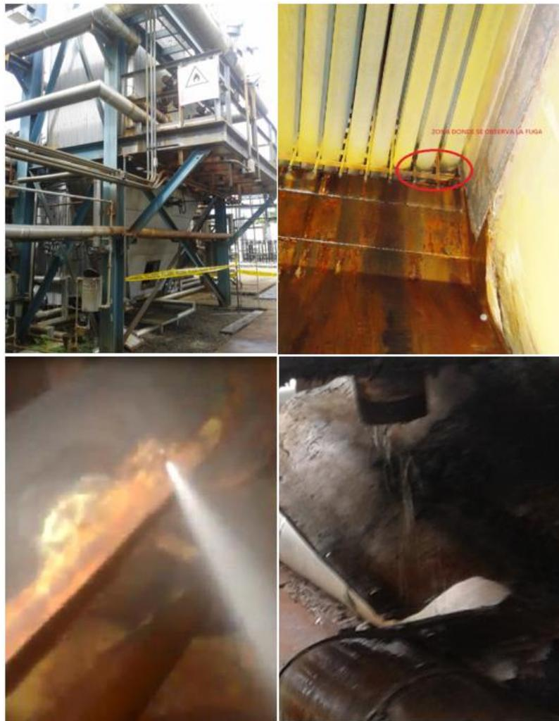
Figura 3. 13: *Rotura de Tubo del Economizador por Erosión Externa.*
