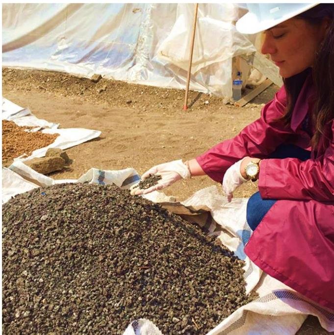
**Ilustración 28. Lodo residual posterior al proceso de secado.**
