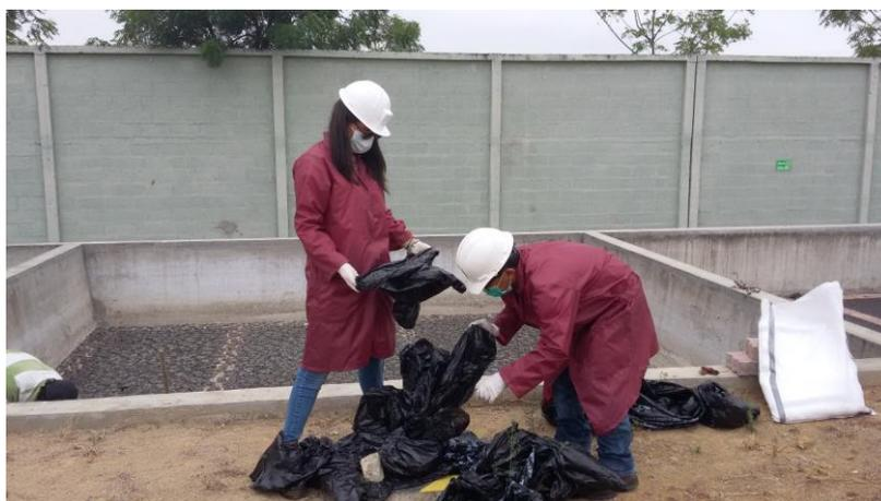
**Ilustración 22. Muestreo de lodos residuales (material tipo B).**
