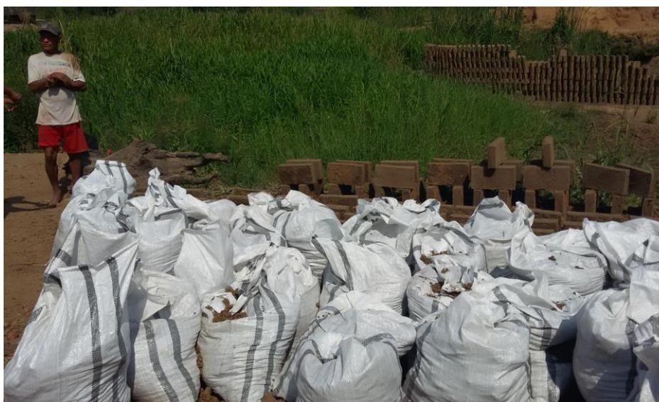
**Ilustración 18. Arcilla expansiva (material tipo A) extraída y dispuesto para su traslado a la cámara de secado.**
