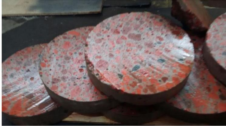
**Ilustración 48. Grava granulométrica, arena más grava de arcilla con adiciones de lodos residuales en el hormigón ligero.**
