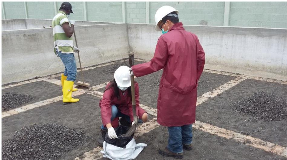
**Ilustración 21. Muestreo de lodos residuales (material tipo B).**
