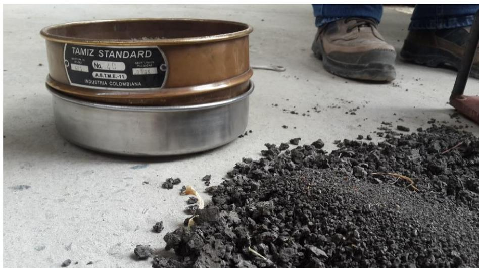
**Ilustración 31. Ensayos del laboratorio del lodo residual (material tipo B), proceso de tamizado.**
