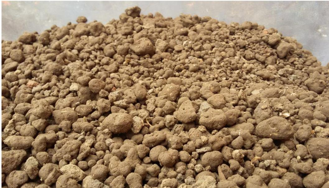
**Ilustración 46. Grava granulométrica, arena más grava de arcilla con adiciones de lodos residuales.**
