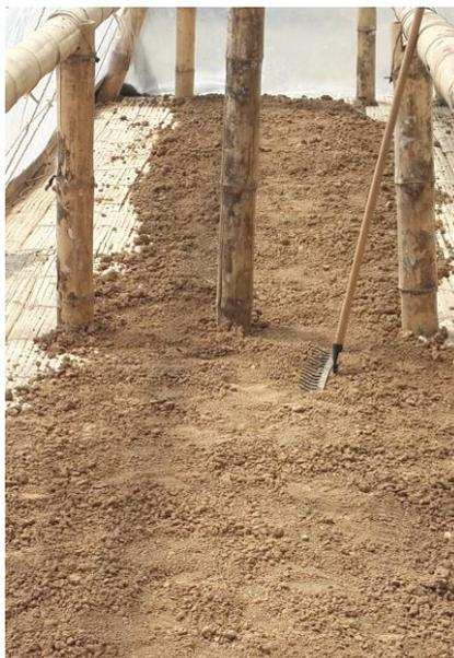
**Ilustración 23. Arcilla expansiva (material tipo A) dentro de la cámara de secado.**
