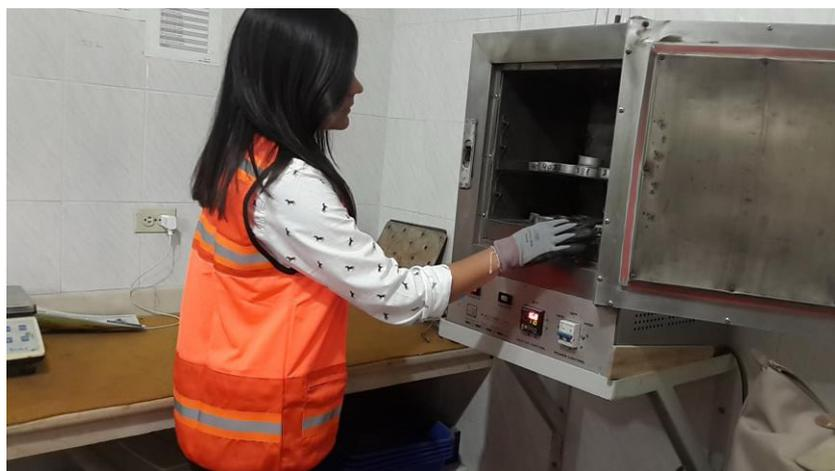
**Ilustración 34. Ensayos en el laboratorio de los materiales analizados, ingreso de las muestras al horno.**
