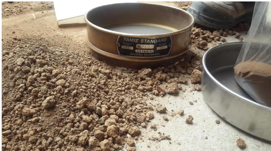
**Ilustración 30. Ensayos del laboratorio de la arcilla expansiva (material tipo A), proceso de tamizado.**
