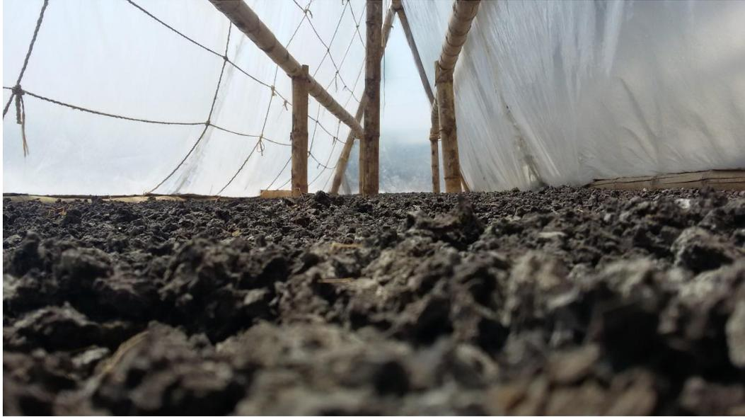
**Ilustración 24. Lodos residuales (material tipo B) ubicado dentro de la cámara de secado.**
