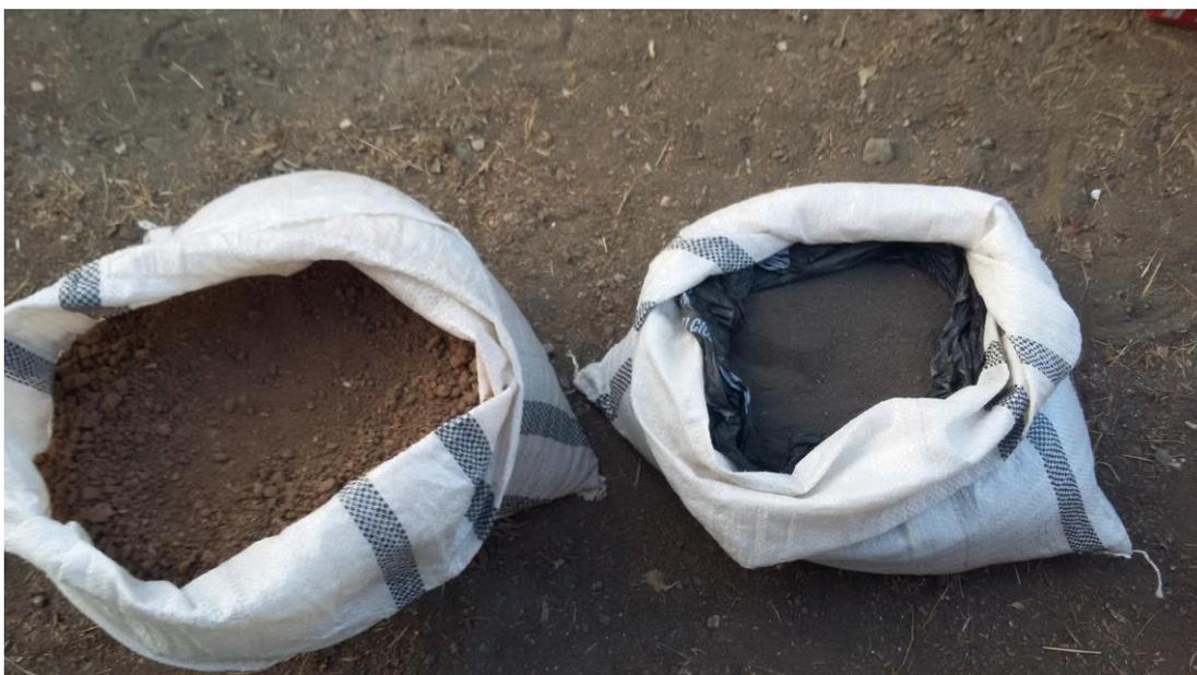
**Ilustración 29. Muestras de arcilla expansiva y lodo residual posterior al proceso de secado.**
