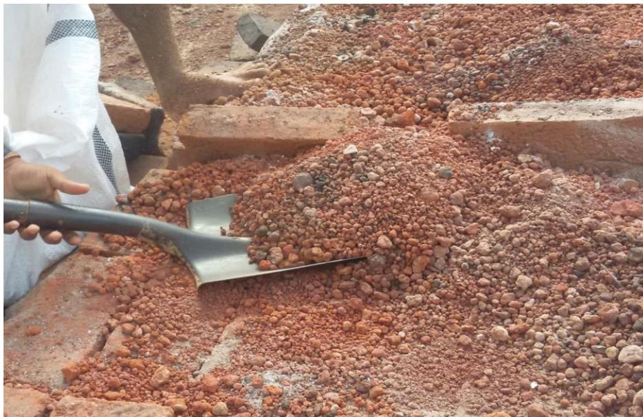
**Ilustración 47. Grava granulométrica, arena más grava de arcilla con adiciones de lodos residuales después de cocción.**
