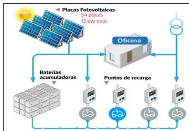
Figura 5.9 Diagrama de bloque de una electrolinera
