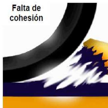
**Figura 2.6. Pérdida de cohesión del mástico asfáltico**
