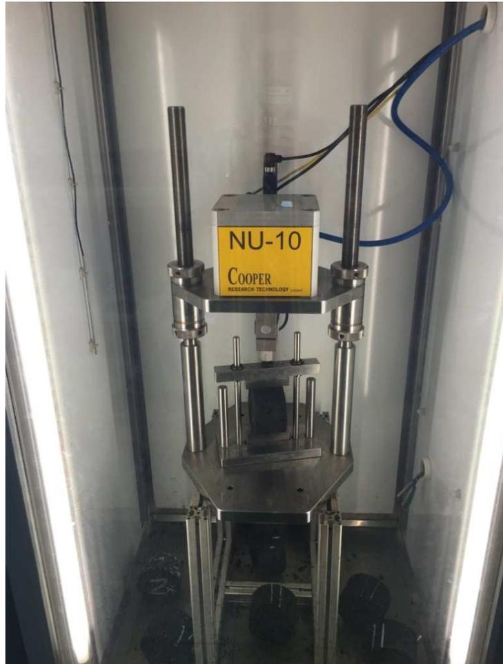
**Figura 2.21. Ensayo de fatiga con equipo NAT**
