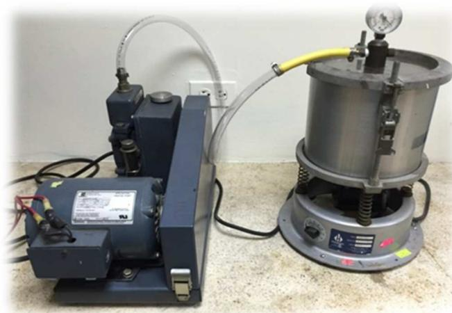
**Figura 2.12. Picnómetro y bomba de vacíos**
