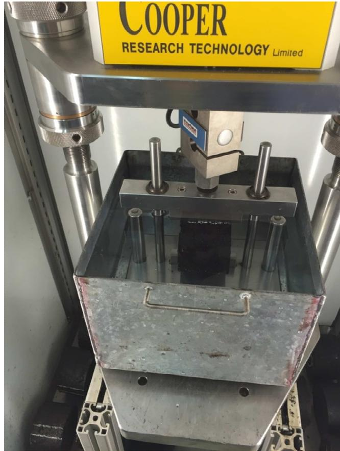
**Figura 2.23. Ensayo de fatiga en equipo NAT con inmersión**
