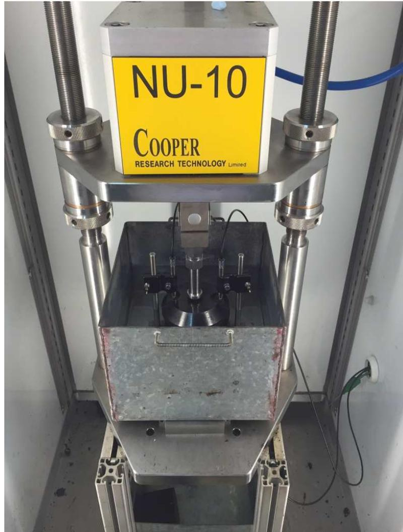
**Figura 2.25. Ensayo de deformación bajo compresión cíclica en equipo NAT con inmersión**
