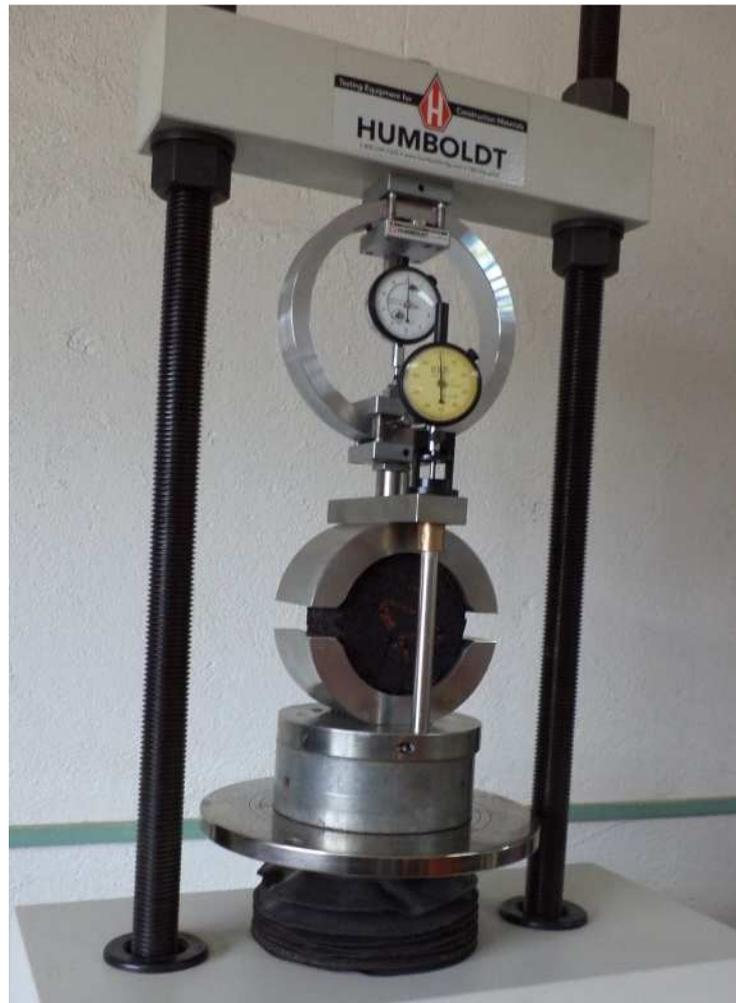
**Figura 2.16. Ensayo de estabilidad Marshall**
