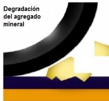
**Figura 2.7. Degradación del agregado mineral**
