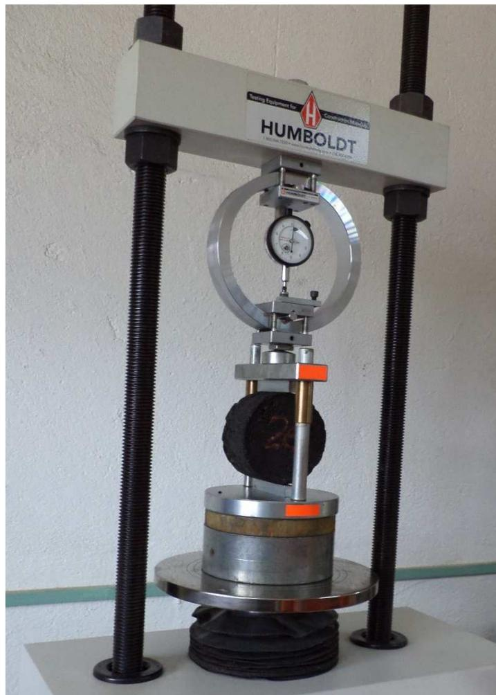
**Figura 2.15. Ensayo de tracción indirecta**
