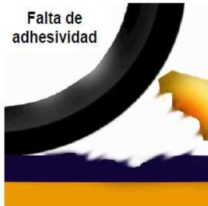
**Figura 2.5. Fallas en la adherencia entre el agregado y asfalto.**
