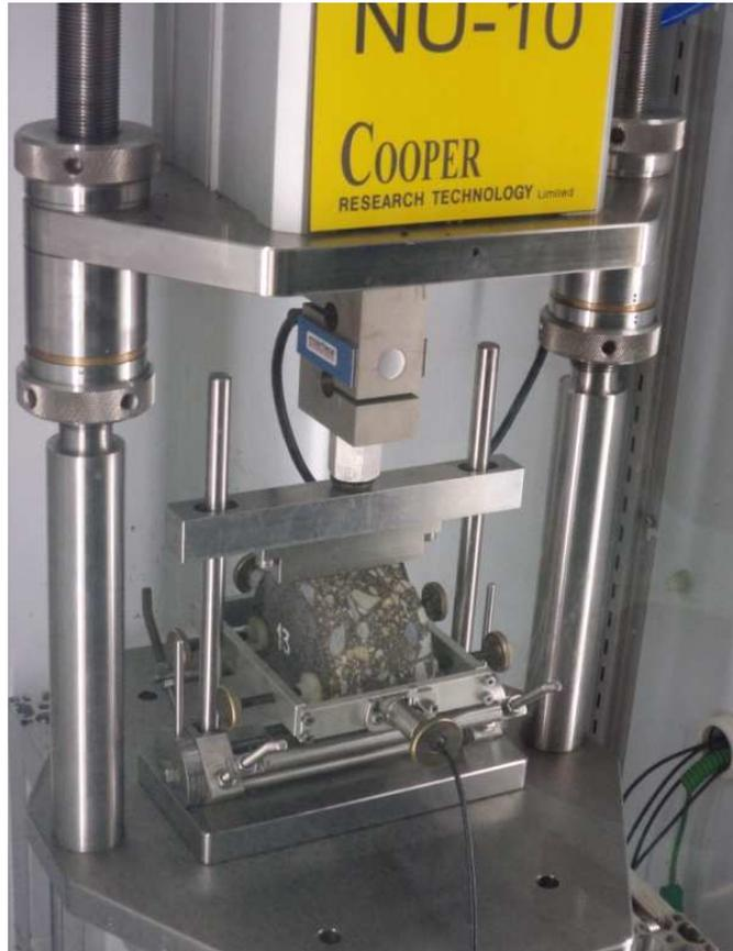
**Figura 2.17. Ensayo de módulo de rigidez con equipo NAT**
