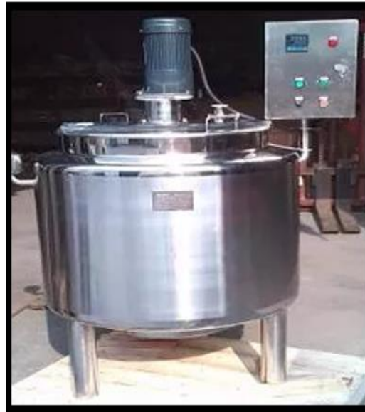
Ilustración 45: Paila Osmótica Industrial
