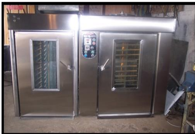
Ilustración 46: Deshidratadora por bandeja (Secador 4 coches)
