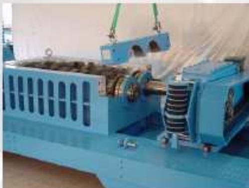
El motor y la caja de cambios es desplazable sobre guías para un rápido cambio de ejes
