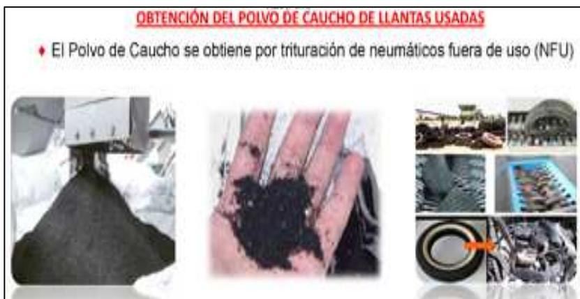
Figura 7. Utilización del neumático
