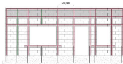
Figura 19: Esquema pared estructural de mampostería Fuente: Masonry Institute (2014)
