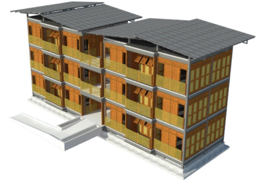
6. PAREDES VIVIENDA EXPANDIDA: PANELES DE MADERA Y CAÑA PICADA. PANELES INTERIORES TIPO PLAS BAM DE ECO-MATERIALES.
