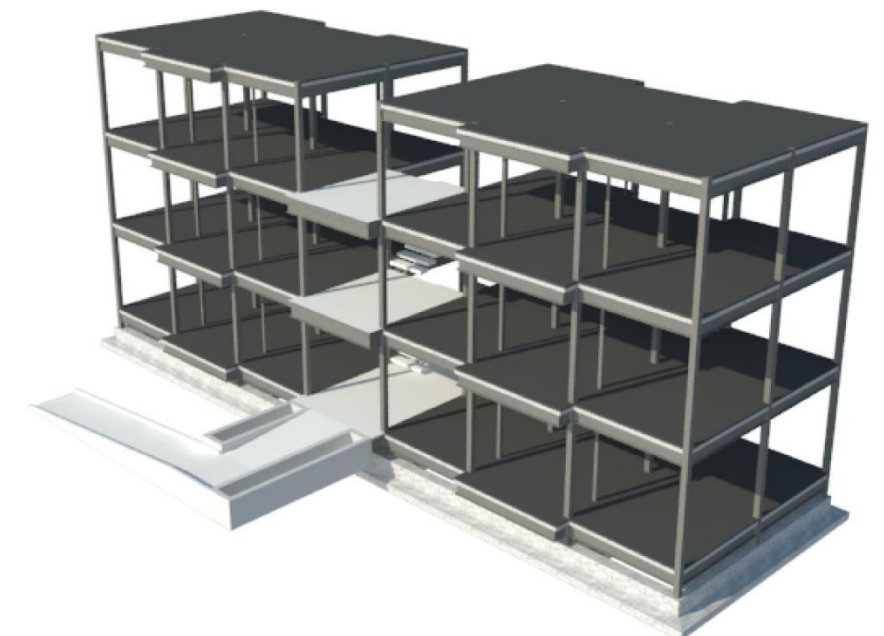
3. LOSAS: PLANCHAS NOVALOSA Y RECUBRIMIENTO DE CONCRETO PULIDO. RAMPA DE HORMIÓN
