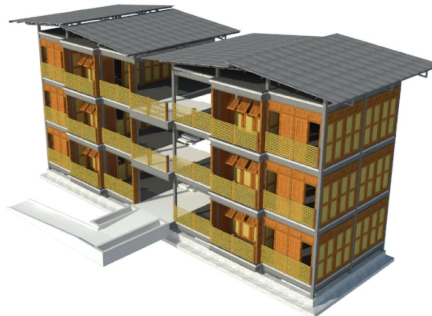
5. PAREDES VIVIENDA MÍNIMA: PANELES EXTERIORES DE MADERA Y CAÑA PICADA. PANELES INTERIORES TIPO PLAS BAM DE ECO MATERIALES.
