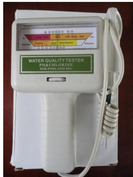
Foto N°3: Medidor de cloro y pH del agua. Pool Electro Tester.
