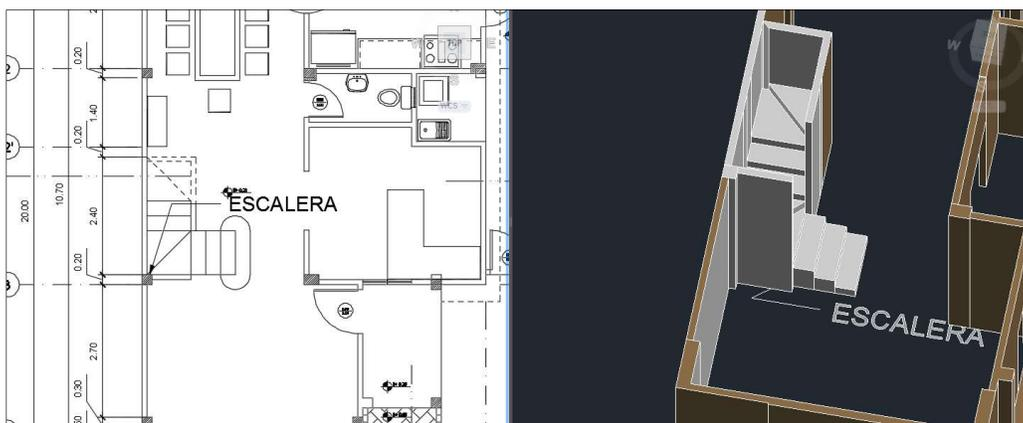
Figura N° 7 Representación de las Escaleras en planta y 3D de los planos CAD
