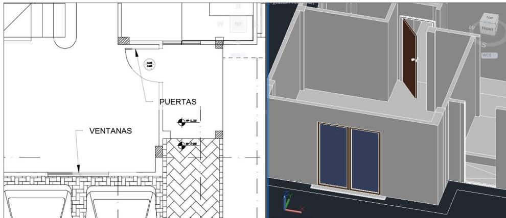
**Figura N° 9 Representación en CAD de puertas y ventanas**
