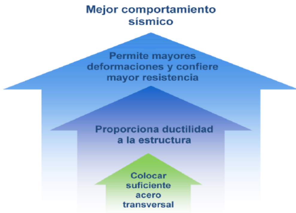
Figura 70 Importancia del Acero en el Comportamiento Estructural
