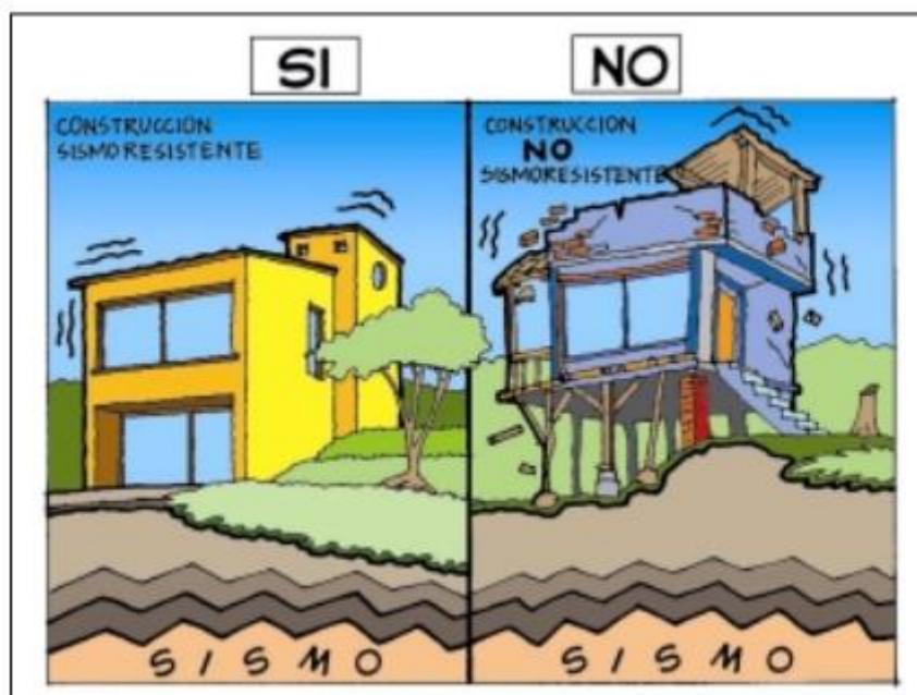
Figura 3 Comportamiento edificaciones sismo resistentes
