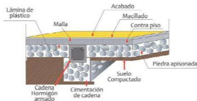
Figura 29 Detalle del Contrapiso
