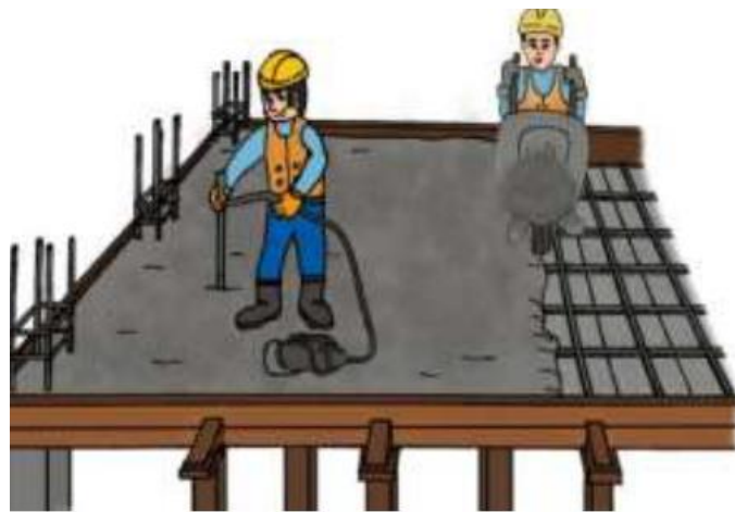
Figura 49 Fundición y Vibración de Losa Alivianada
