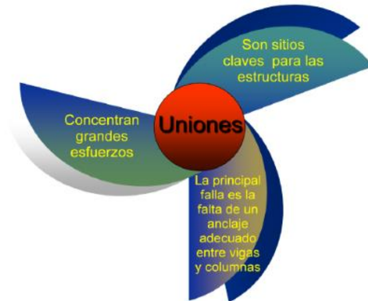
Figura 81 Importancia de las Uniones Junta Vigas-Columnas
