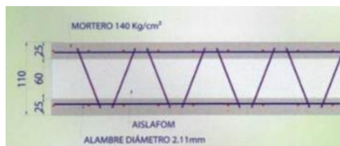
Figura 6 Paredes Portantes Aislaform
