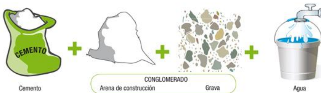
Figura 10 Componentes del Hormigón
