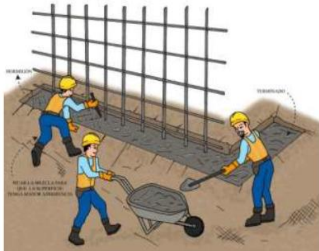
Figura 20 Fundición del Pie del Muro de Contención
