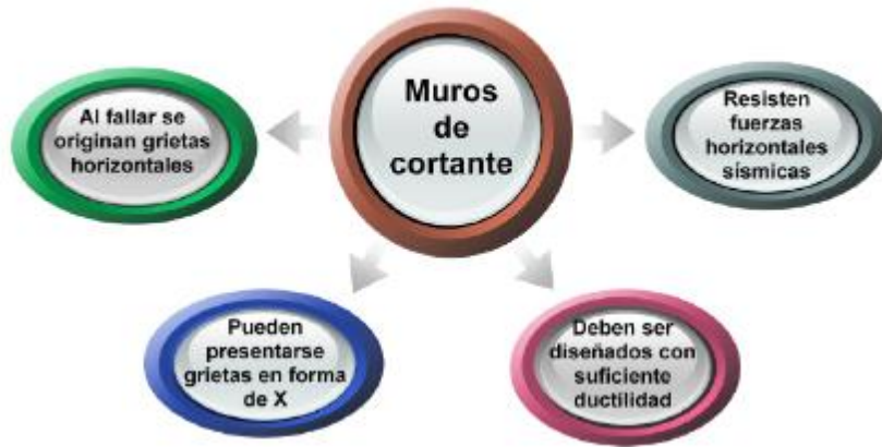
Figura 86 Características y Fallas del Muro de Cortante
