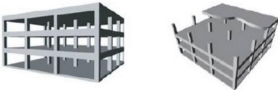
Figura 8 Edificaciones con sistemas Aporticado
