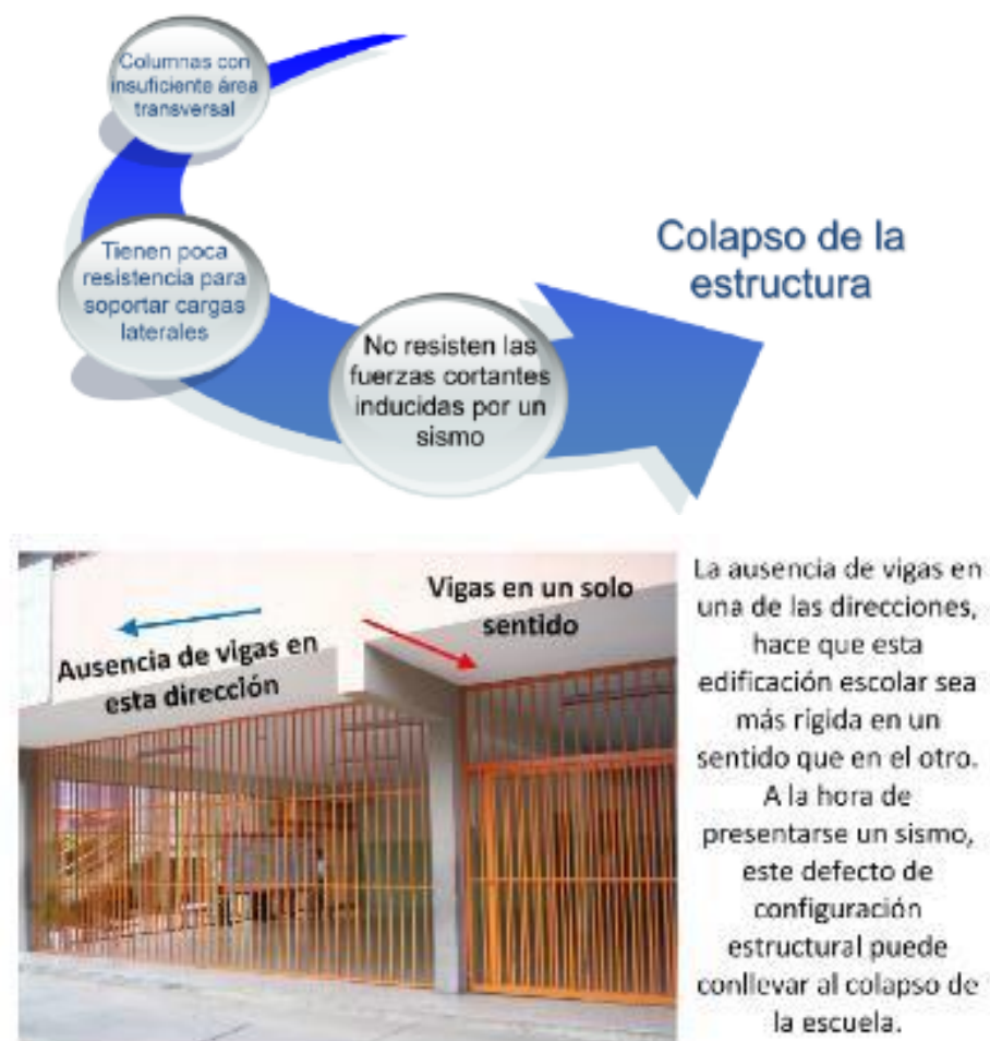
Figura 77 Fallas por insuficiencia de secciones transversales ante un Sismo
