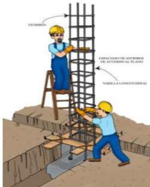
Figura 30 Armadura de Columna
