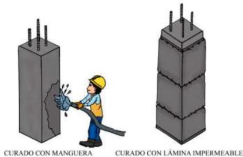
Figura 15 Curado del Hormigón
