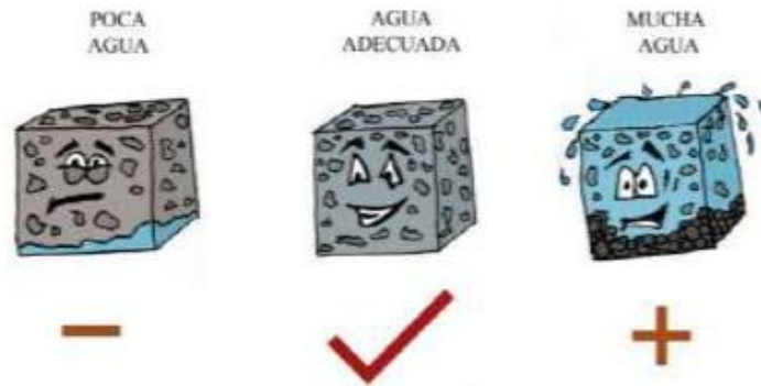
Figura 12 Relación de agua con el hormigón
