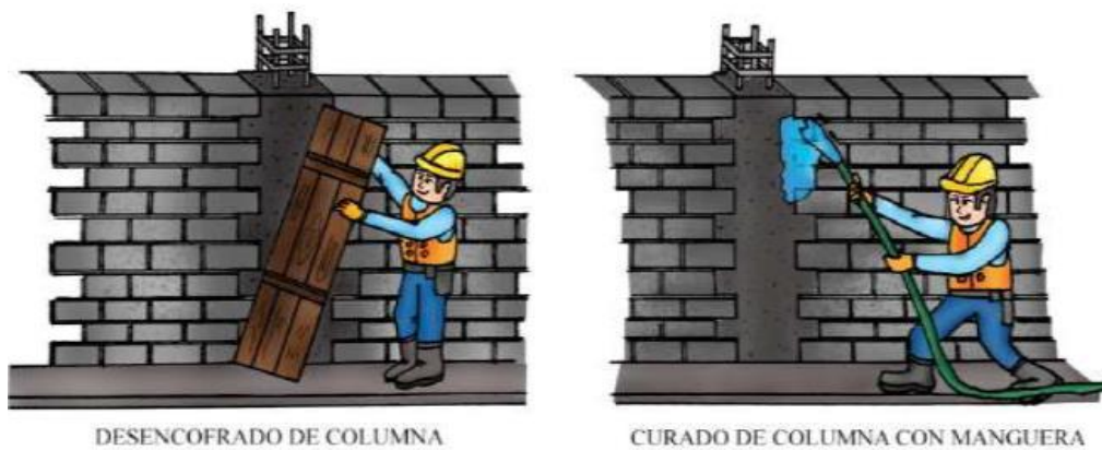
Figura 34 Encofrado de Columnas
