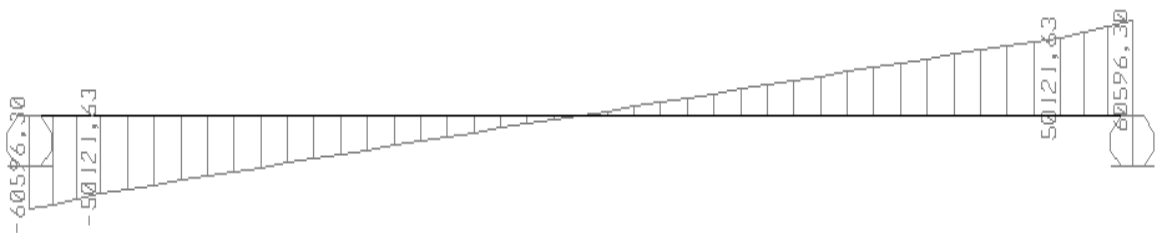
Figura 98: Diagrama de cortante debido al peso propio + losa + asfalto, barandas y postes, LRFD
