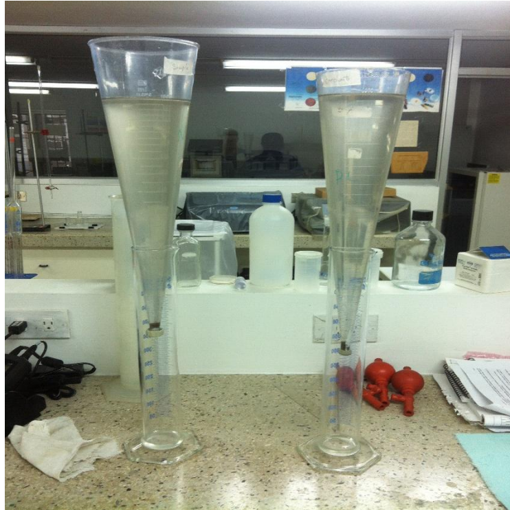
Ilustración 15. Prueba del Cono Imhoff para velocidad de sedimentación
