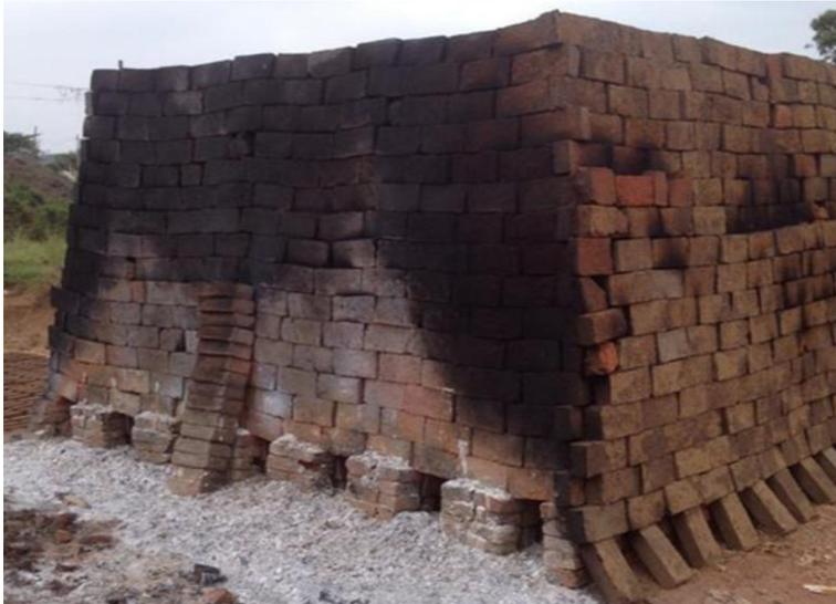
**Ilustración 29.** Pirámide de cocción posterior al proceso de incineración del material. Fuente: Tesis de Grado de Ing. Xavier Orellana (2015).
