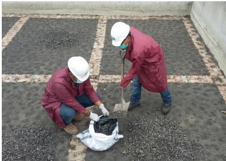
**Ilustración 25.** Recolección de lodos residuales en celda de deshidratación. Fuente: Tesis de Grado de Ing. Antonio Moncada (2016).
