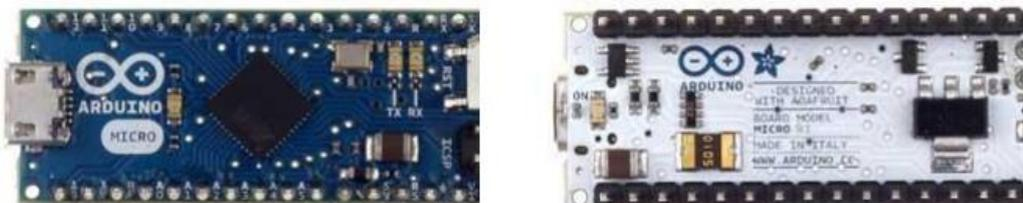
Figura 2. 8: Placa del Arduino Micro frontal/posterior.
