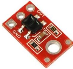
Figura 3. 2: Sensores Pololu QRT-1RC
