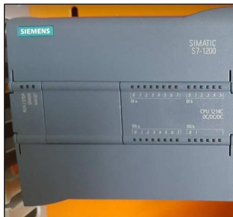
Figura 2. 6: PLC modelo S7-1200 marca Siemens.
