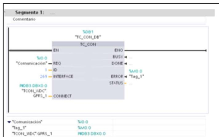
Figura 3. 23: Configuración de bloque de comunicación TC\_CON
