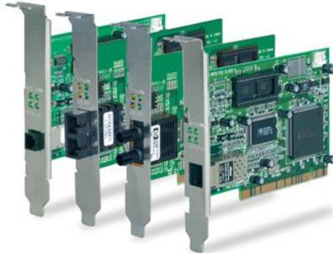
**Figura 2. 5: Diversas tarjetas para conexión a la red**
