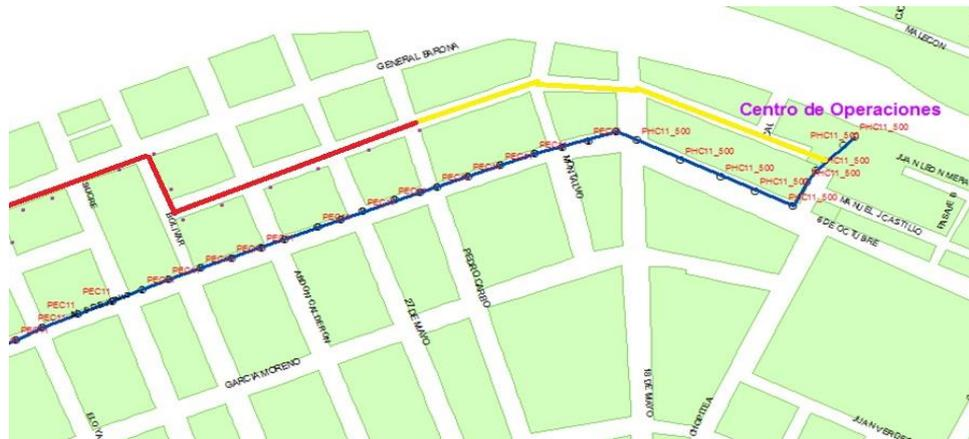
Figura 3. 5: Salida de la fibra del Centro de Operaciones.
