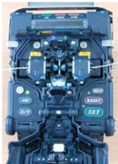
Figura 2.12: Fusionadora de fibra óptica.
