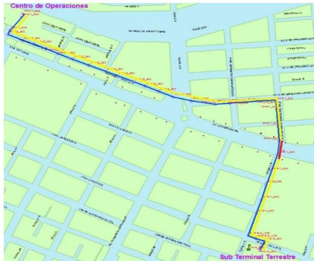
Figura 3. 14: Recorrido de la fibra óptica para la subestación Terminal Terrestre.
