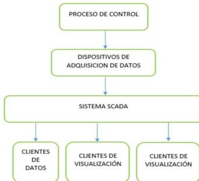
Figura 2.17: Esquema de un sistema SCADA implementado.
