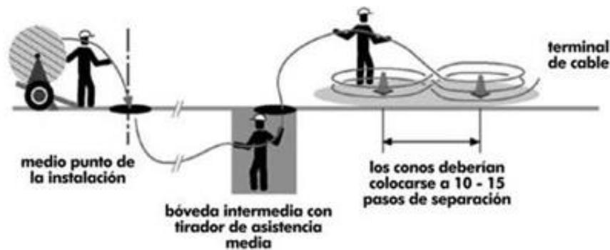
Figura 2.11: Instalación de cable canalizado y manejo durante el tendido.
