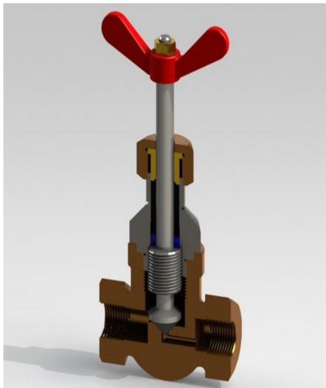
Figura 2. 13: Dispositivo de expansión.
