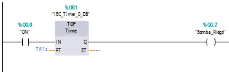
Figura 3. 13 Noveno segmento encendido de la bomba de riego
