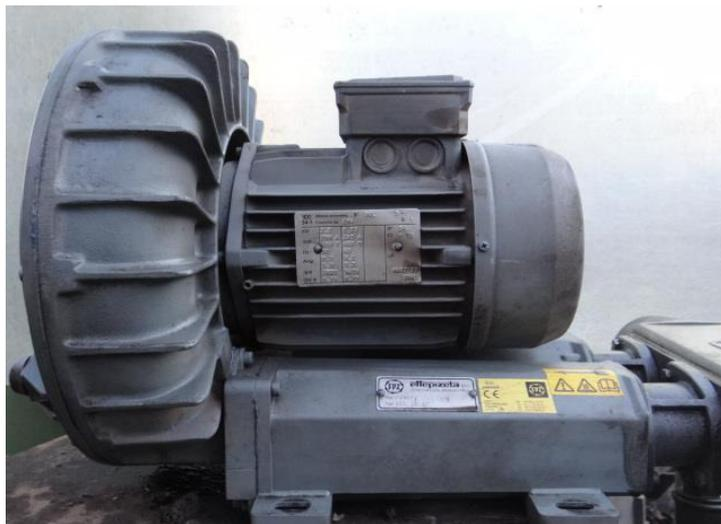
**Figura 5.4** Sopladores de canal lateral.
