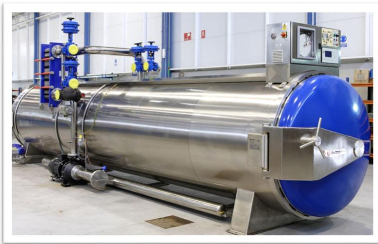
Figura 35. Esterilización a vapor
