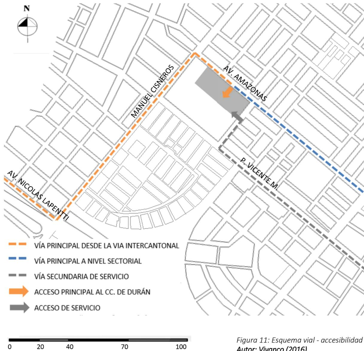
Figura 11: Esquema vial - accesibilidad
