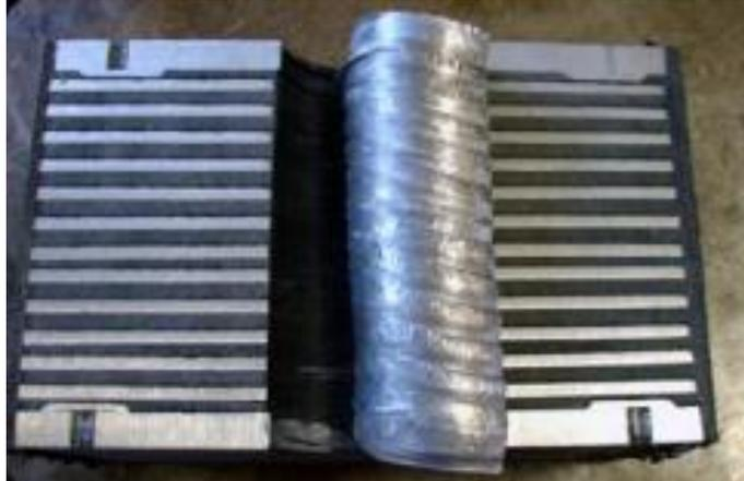
**Ilustración 5: Aislador elastomérico con núcleo de plomo (LRB)**
