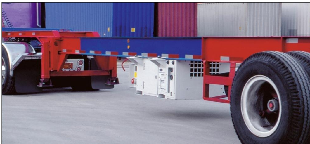
Gráfico N. 20 Flat chasis con gen set instalado
