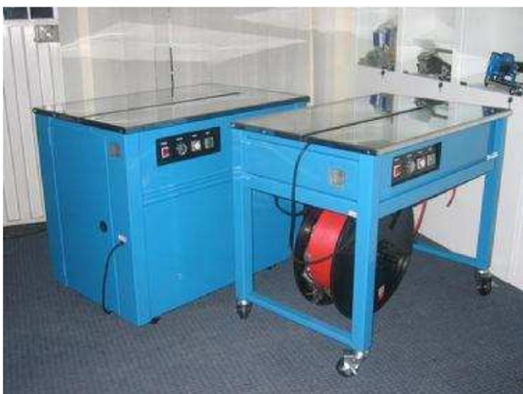
Máquinas zunchadoras marca TRANSPAK
