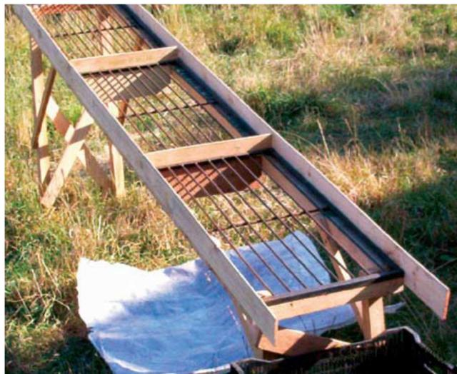
*Fig. 16 Calibradora de Tamaño de tallos*
