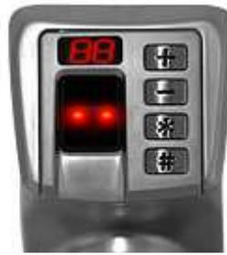
**Figura 2-2 Panel de la cerradura biométrica**
