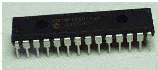
**Figura 4-1 Microcontrolador PIC 18F2550**
