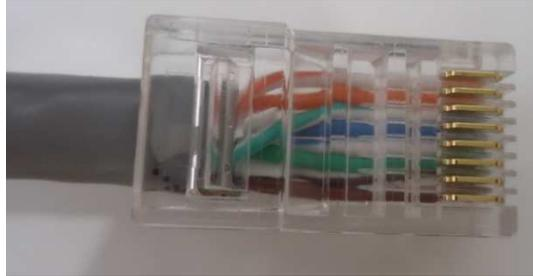
**Figura 3.19: posición de los cables para ser ponchados correctamente.**
