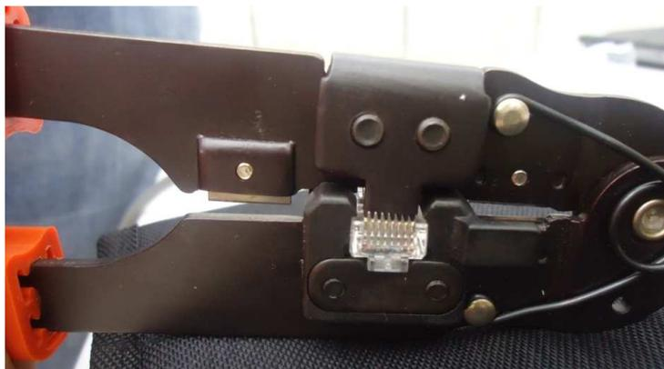
**Figura 3.20: Ponchado del cable y conector RJ45**
