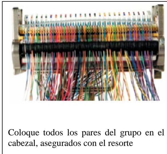
**Figura 3.42 Hilos conectores colocados en el cabezal**
