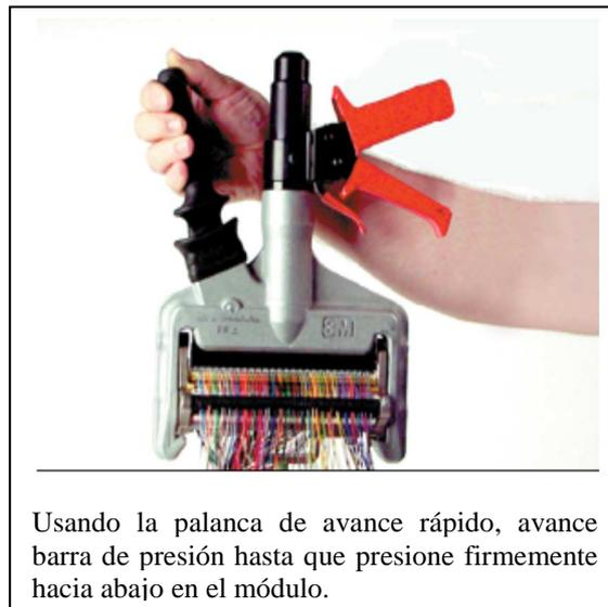
**Figura 3.48** Compresión con la herramienta manual
