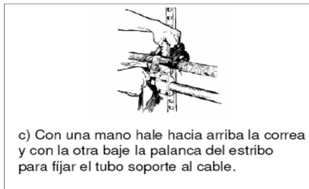
**Figura 3.28 Para asegurar correas y estribos**
