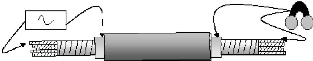
**Figura 2.3 Numeración con microteléfono y generador de señal**
