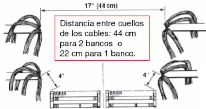
**Figura 3.25 Colocación de los cables**
