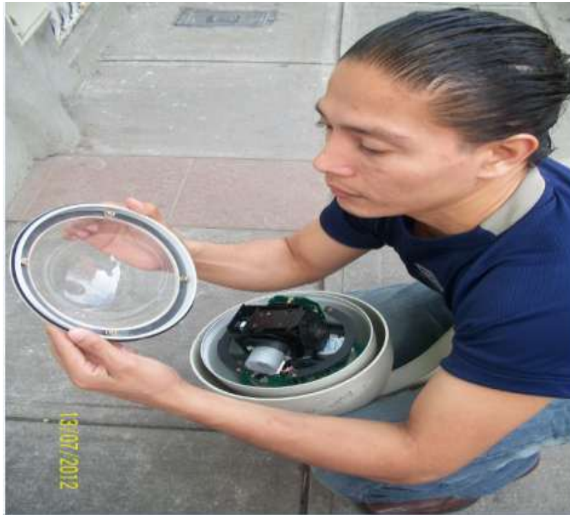
Grafico 4.6 Implementación Fase 1: Instalación de tapa Protectora a la unidad Domo.
