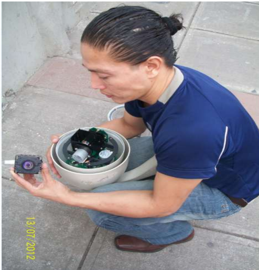
Grafico 4.3 Implementación Fase 1: Instalación del Lente a la unidad Domo.
