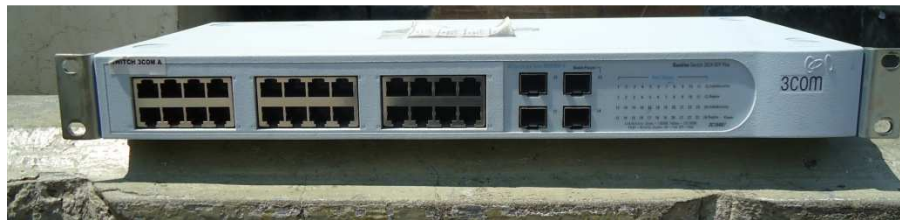
Figura 2. 18: Equipo switch 3COM A.
