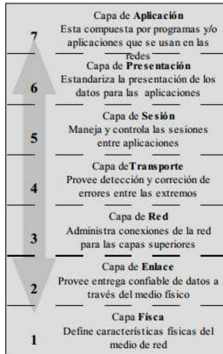
Figura 1. 17: Modelo referencial OSI. (Íñigo G. & Barceló O., 2009)
