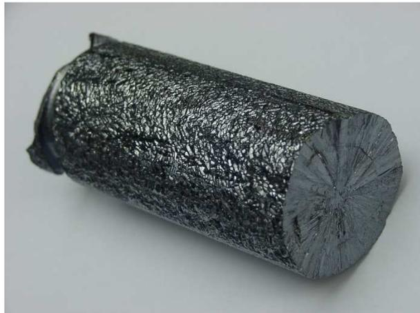
Figura 3.8: Barra de silicio policristalino<sup>15</sup>.
