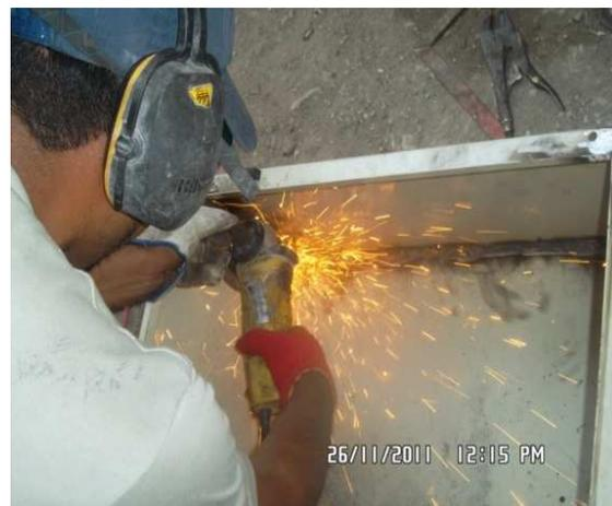
**Figura 5.8** Construcción y pulido de gabinete
