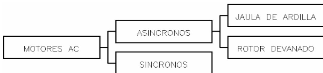
**Figura 2.7** Clasificación de los motores trifásicos.
