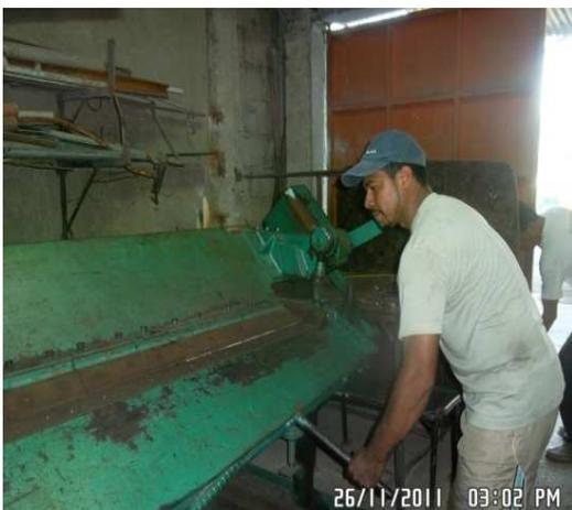
**Figura 5.7** Doblado de planchas metálicas
