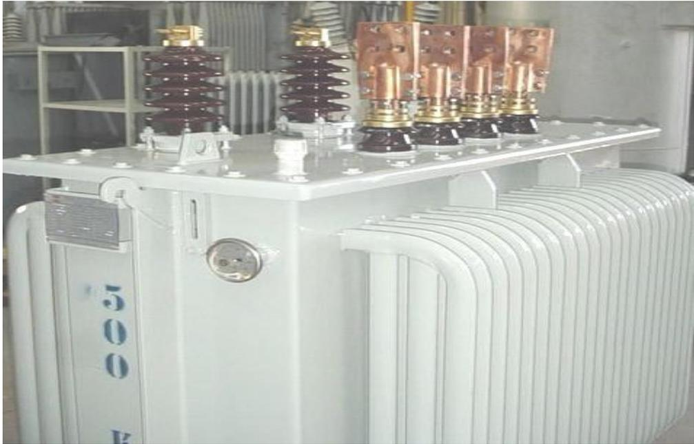
FIG 3.1 TRANSFORMADOR DE DISTRIBUCIÓN
