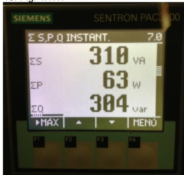
Fig. 4.1.17 Medición de sumatorias de potencia del motor
