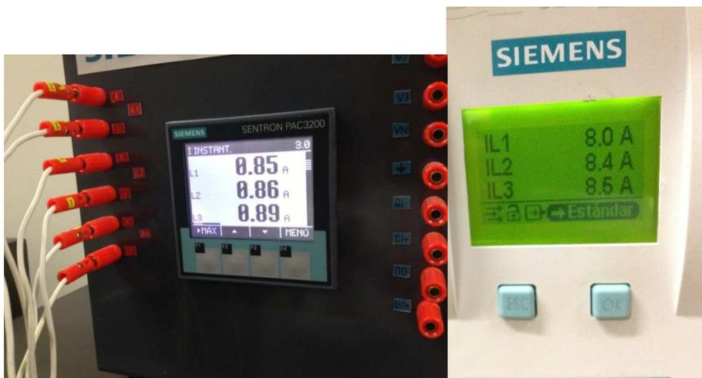
Fig 4.1.11 Medición de corriente con SentronPac 3200
