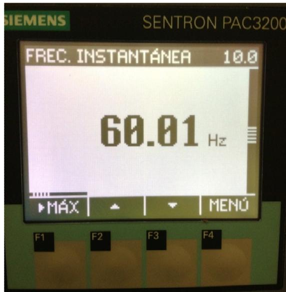
Fig. 4.1.20 Medición de la frecuencia del motor con SentronPac 3200
