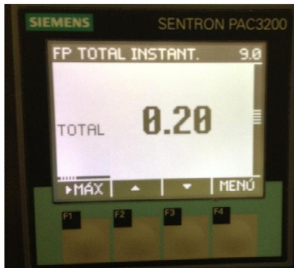
Fig. 4.1.19 Medición del FP Total del motor con SentronPac 3200
