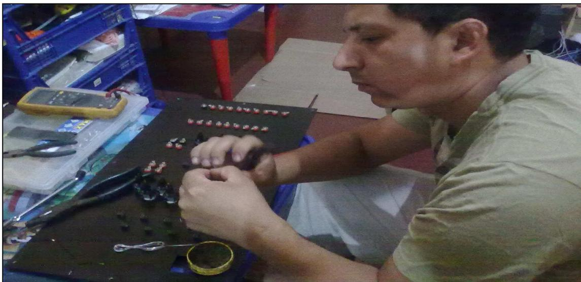
**Figura 3.35 Conexión de interruptores y luces piloto.**
