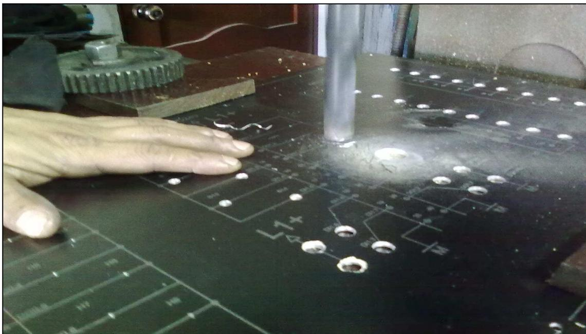
**Figura 3.32 Perforaciones para luces piloto.**
