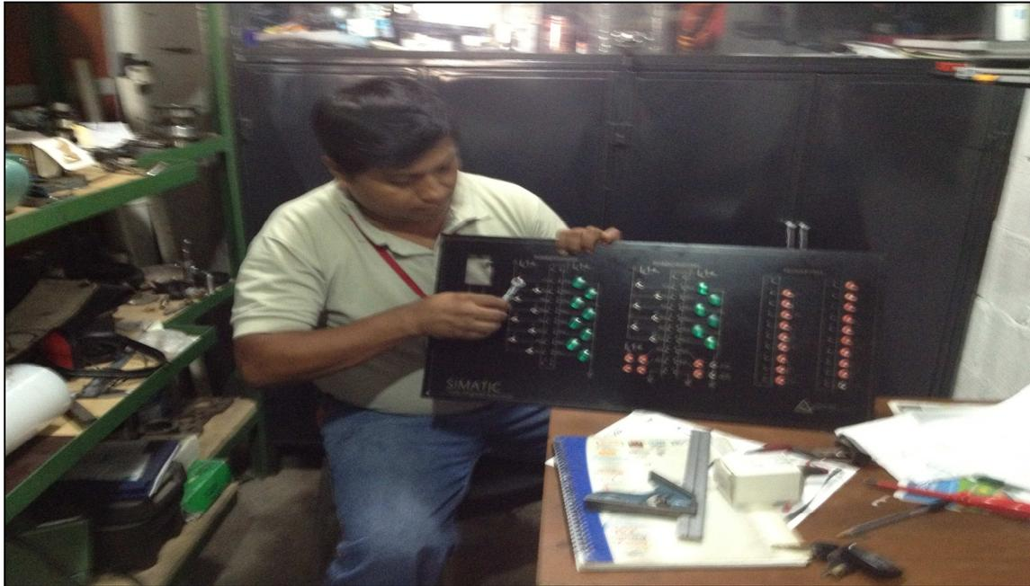
**Figura 3.34 Montaje de interruptores y luces piloto.**
