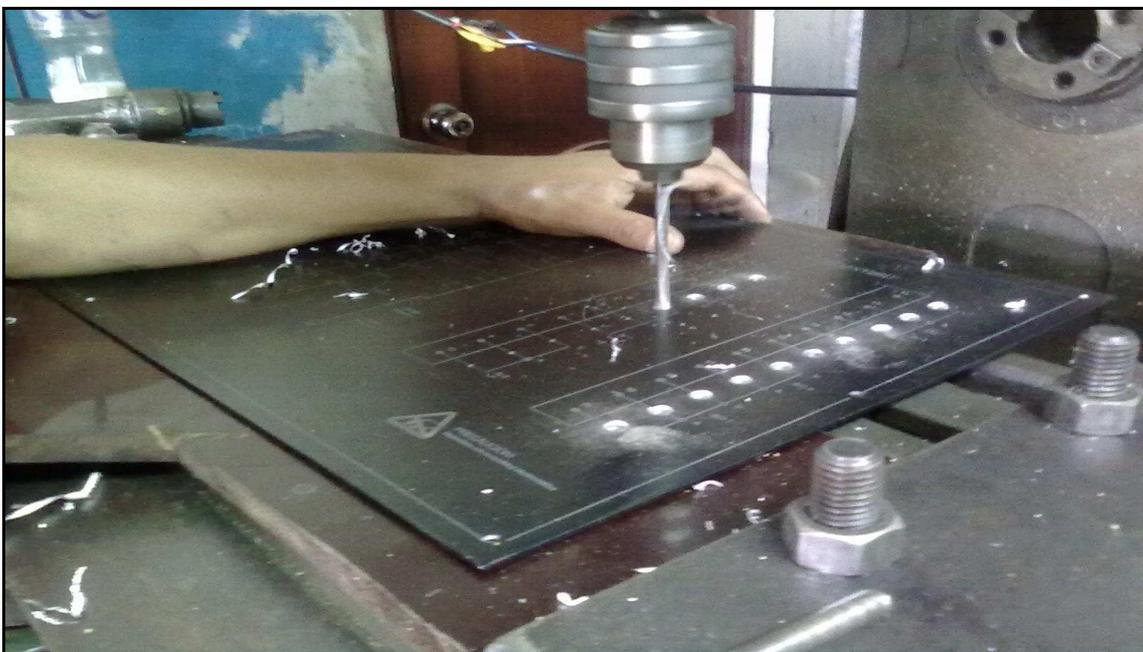
**Figura 3.31 Perforaciones para interruptores.**
