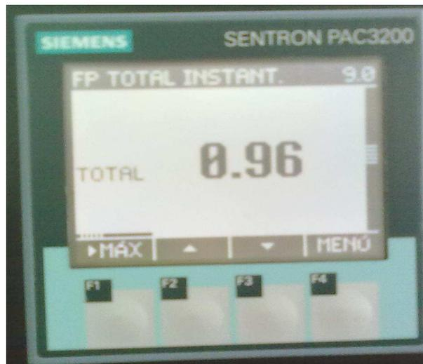
**Figura 4.7 Medición de factor de potencia mejorado**
