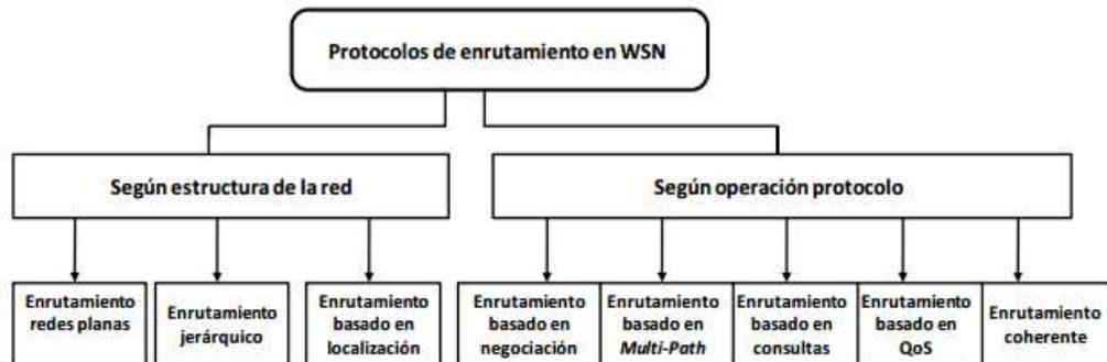
Figura 2. 11. Clasificación de protocolos de enrutamiento para WSN
