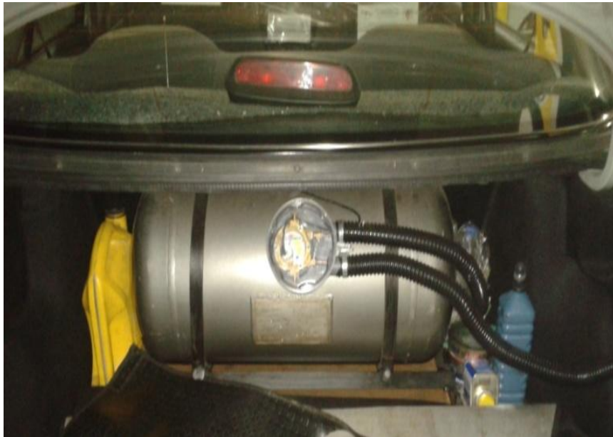
TANQUE DE GAS ADAPTADO EN LA PARTE POSTERIOR DEL VEHÍCULO
