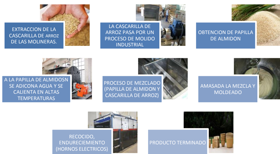
Figura 8. Proceso de la elaboración de suministros de la cascarilla de arroz
