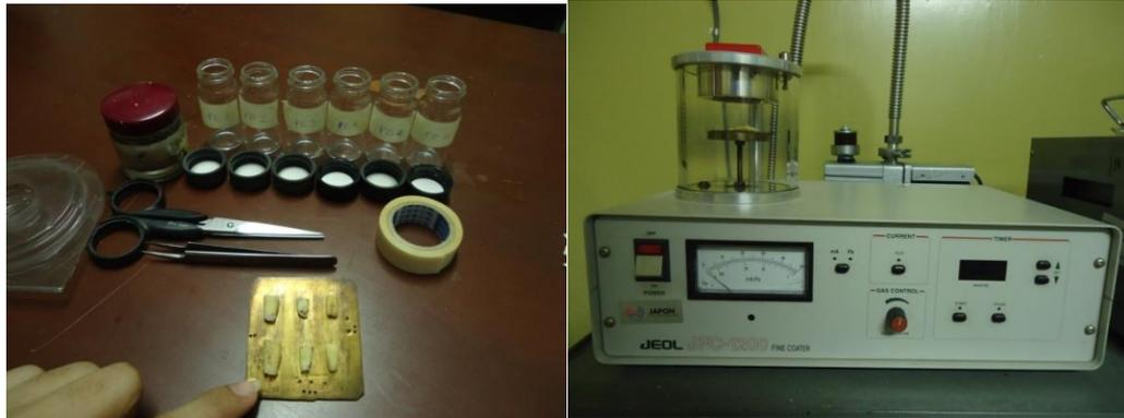
**Foto N° 10: A. Montaje de las muestras B. Recubrimiento con metal (oro).**
