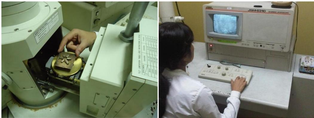
**Foto N° 11: A. Colocación de las muestras en la cámara de vacío del MEB
