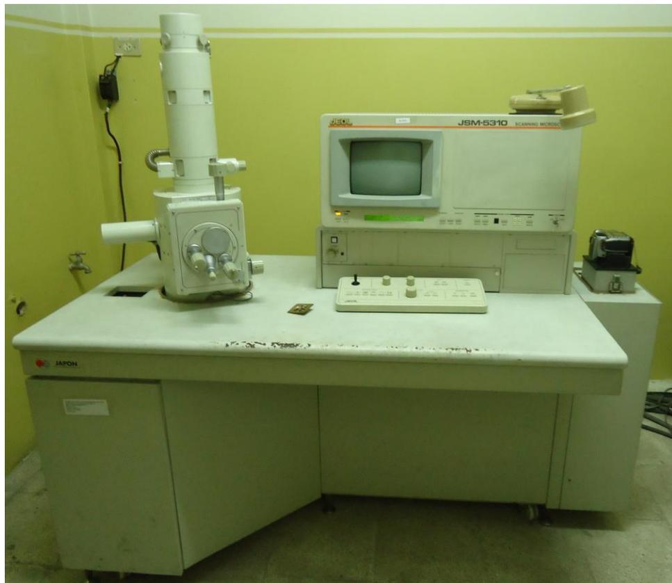
**Foto N° 5: Microscopio Electrónico de Barrido JSM-5310 (MEB).**
