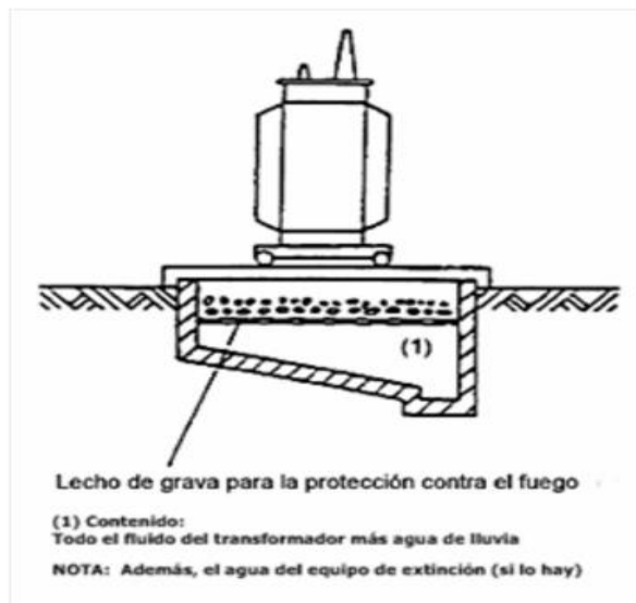
Figura 3. 3. Foso de recogida con depósito colector integrado.
