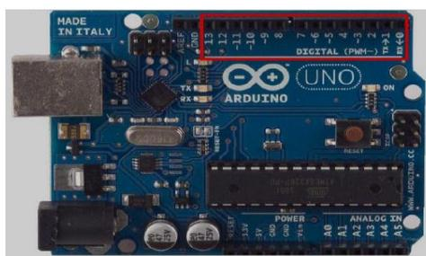
**Figura 2. 21: Arduino UNO, salidas digitales**
