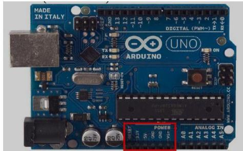
**Figura 2. 20: Arduino UNO, pines de alimentación**
