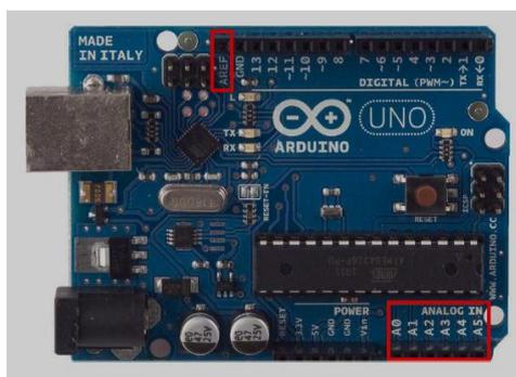
Figura 2. 22: Arduino UNO, entradas análogas
