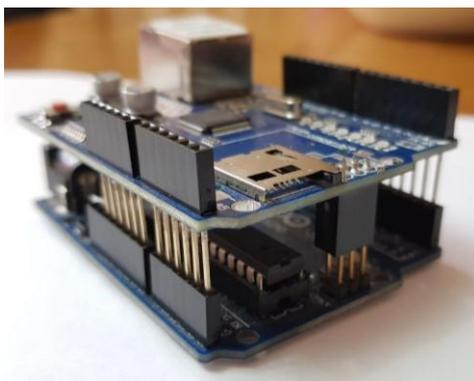
**Figura 3. 35: Acoplamiento del módulo Ethernet con la Arduino**
